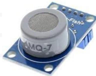
Figura 37: Sensor de gases MQ7
